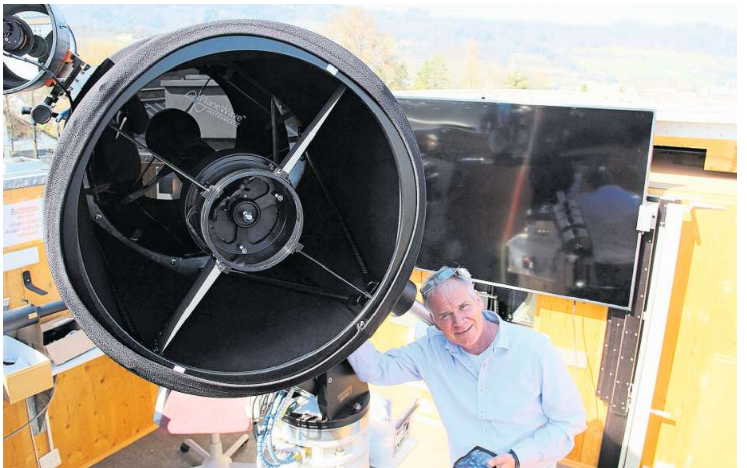
Die Zahl 20 im Namen des neuen Fernrohrs CDK20 steht für 20 Zoll und bezieht sich auf den Spiegel des Teleskops. Dieser hat einen Durchmesser von einem halben Meter. Mathematik- und Physiklehrer Benedikt Götz hat ganze Nächte auf dem Kantonsschuldach verbracht, um sich mit dem neuen Wundergerät vertraut zu machen.
